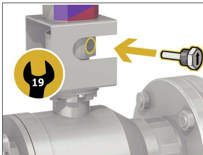
6) No final das operações, realinhar de modo a permitir o engate do manípulo, e apertar de novo o perno de bloqueio no furo roscado.
